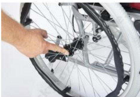
RYCHLOSPOJKA zatláčením na střed se uvolní osa a kolo lze lehce sundat
