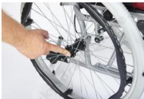
RYCHLOSPOJKA zatlačením na střed se uvolní osa a kolo lze lehce sundat
