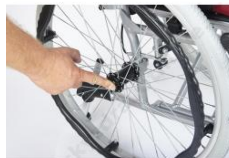
RYCHLOSPÓJKA zatlačením na střed se uvolní osa a kolo lze lehce sundat
